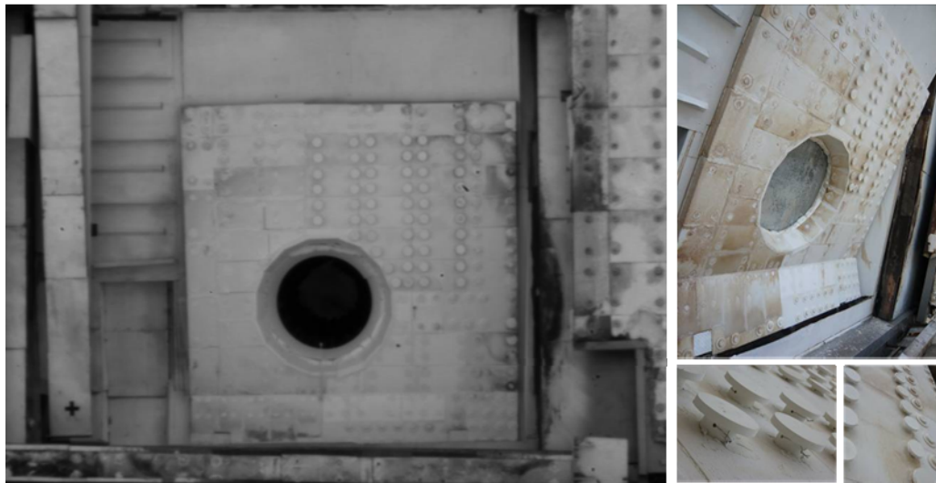
Abbildung 5.1: Aufbau des inhomogenen Strahlungsschutzes des SolHyCo-Testaufbaus
