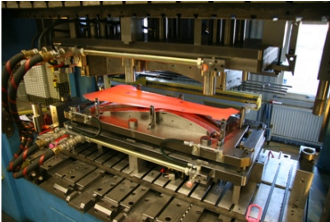
Abbildung 4.10: Glühende Blechplatte in einem Presshärtwerkzeug.
