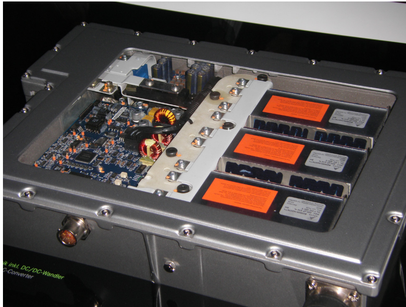
Abbildung 3.5: Umrichter mit integriertem DC/DC-Wandler.
