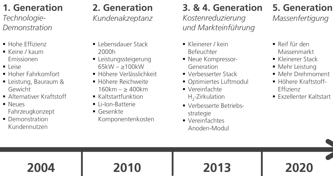
Abbildung 3.17: Entwicklungsphasen in der Evolution von Brennstoffzellenfahrzeugen.
