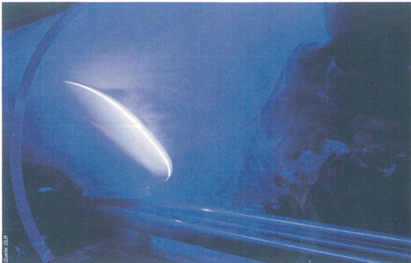
Visualisierte Koptwelle des ICE 3 im Tunnel-Windkanal des DLR
