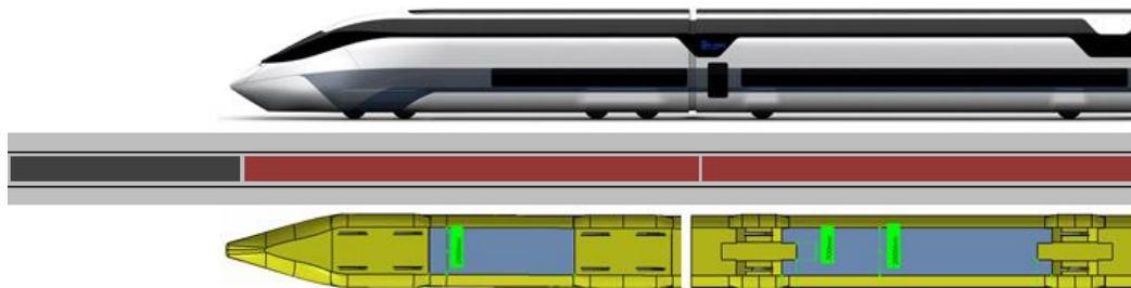
Abb. 8.8: NGT überdeckt FF-Segment vollständig
