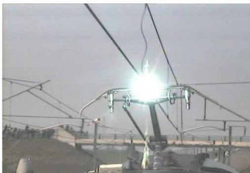
Abb. 2.2: Lichtbogenbildung bei sehr hoher Geschwindigkeit [1]
