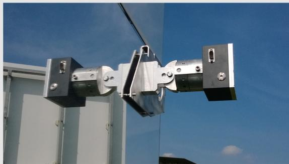
Abb. 1: Sensor angeflanscht an Heliostat
