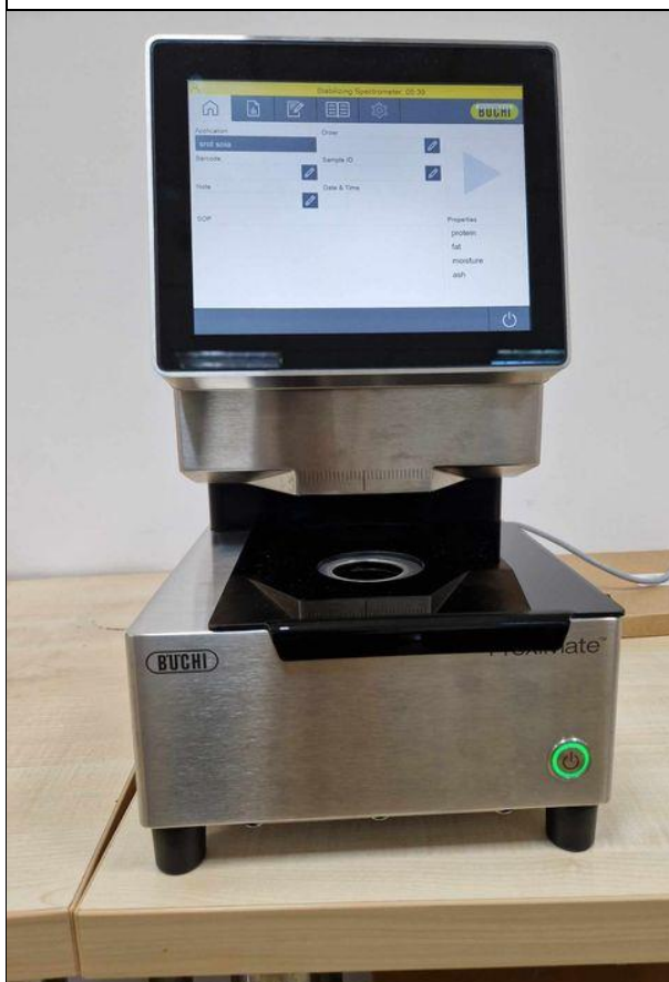
- Analizorul rapid NIR model ProxiMate
