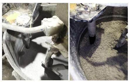
Figure 2-12: Montage expérimental sur le malaxeur 20 litres; la sonde est fixe et orientée vers le bas; la cuve du malaxeur est alors mise en rotation durant l'essai
