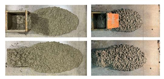
Figure 4-18: Effet du soulèvement de la boîte de confinement pour deux bétons fluides
