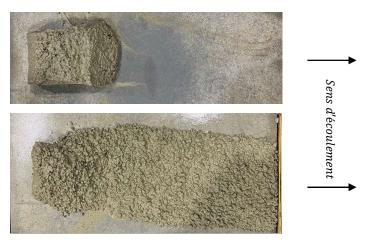
Figure 4-2: Comportements anormaux d'étalement du béton frais sur le plan incliné
