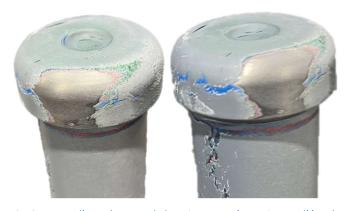
Figure 3-18: Image d'arrachement de la peinture après 5 minutes d'écoulement
