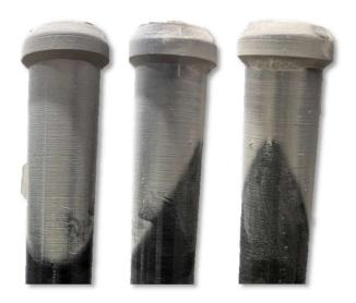
Figure 3-10: Image de la sonde rhéologique après l'expérience: Face à l'écoulement (image de gauche), de côté (image du milieu) et en arrière de l'écoulement (image de droite)
