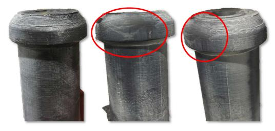
Figure 3-13: Évolution de l'usure de la sonde plastique
