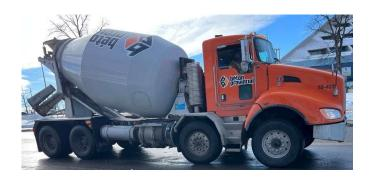
Figure 0-2: Camion de malaxage Béton Provincial équipé du système de sonde rhéologique
