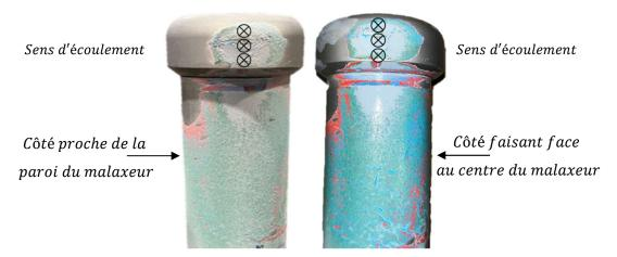
Figure 3-19: Zones d'usure de la sonde après 5h – Vue de face – avant et après traitement de l'image
