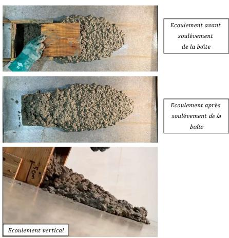
Figure 4-3: Captation vidéo sur le plan incliné
