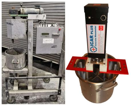
Figure 1-6: Image de gauche: rhéomètre IBB / Image de droite: rhéomètre ICAR
