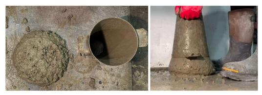
Figure 2-19: Essai d'affaissement au cône d'Abrams
