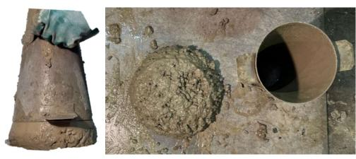
Figure 5-1: Essais d'affaissement au cône d'Abrams
