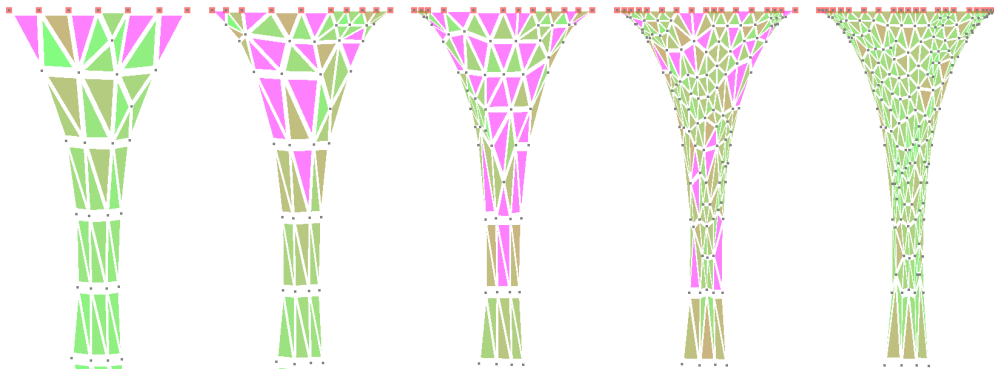
Doctorat de Xavier Faure. Raffinement au cours de la simulation en 2D.
