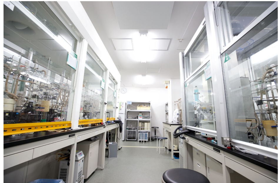
酸性・塩素系薬品対応フードも備えた合成実験室。
