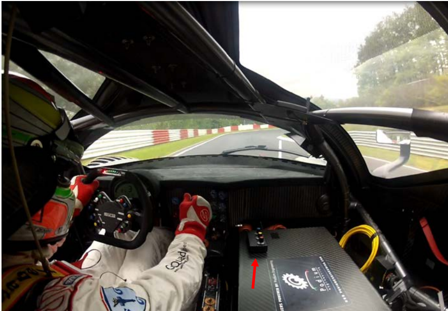
Figura 6.28: Pacco batterie alla destra del pilota
