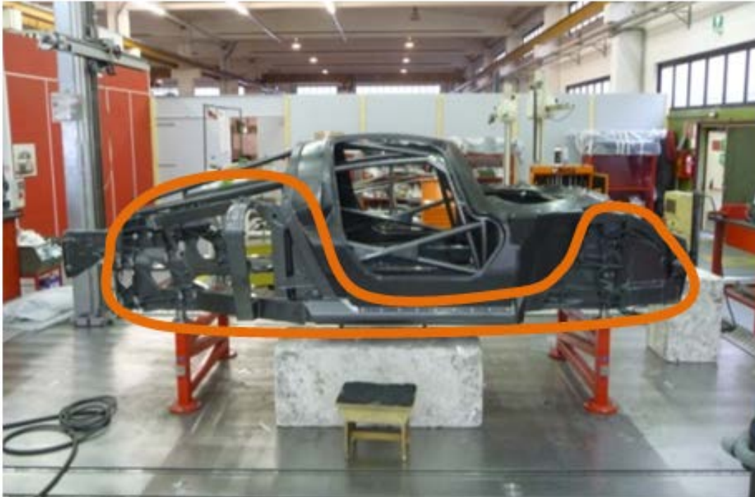
Figura 5.2: Parte del telaio della F430 mantenuta sulla P4/5 Competizione
