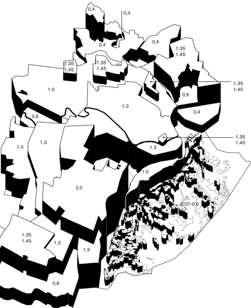
Rappresentazione degli indici di edificabilità assegnati dal PRG alle Zone Normative del Comune di Torino
