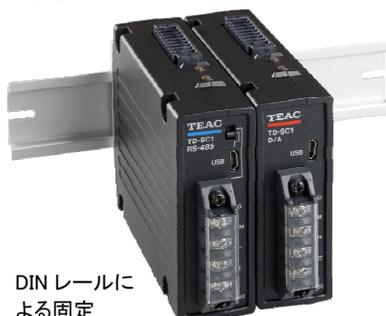
本体のデザインは、機能を必要最低限に抑えた『薄型コンパクト設計』とし、DIN レール固定方式により制御ユニットの省スペース化に対応し、お客様の装置の小型化に貢献します。市場ニーズに応じた低価格実現のため、シンプルな設計コンセプトでありながら、性能面ではティアックのシグナルコンディショナーとしては最速の 20,000 回/秒の高速サンプリングや当社が推進する TEDS によるプラグ & プレイ機能の実装など、全モデルでハイクラス同等の製品仕様を実現しています。
