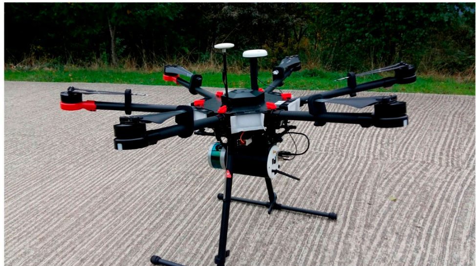
Figure 2. A typical ALS integrated into a drone [21].
