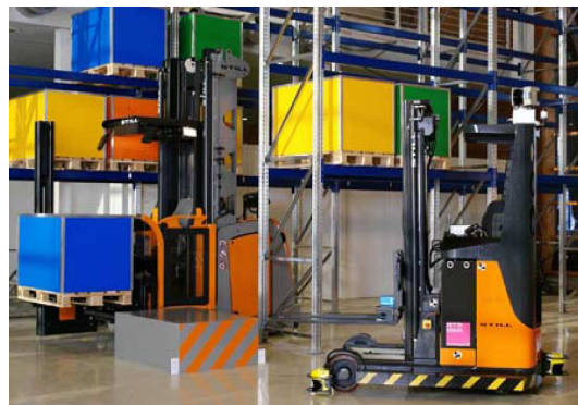
(d) Warehouse with autonomous fork lifter [69].
