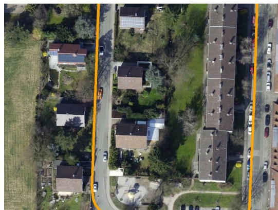
(d) misaligned centerline
