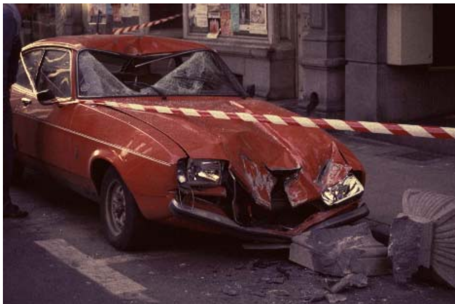
Figure 2.4.18. Chute de garniture en pierre (Liège, 1983)
