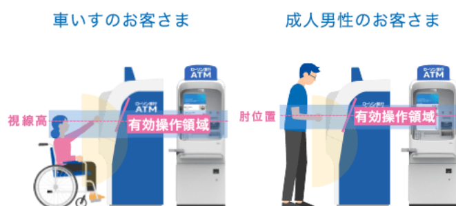
図表 63 ローソン銀行の車いす利用の顧客に配慮した筐体設計
