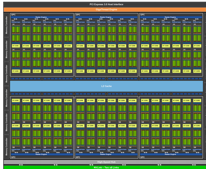
Fig. 12.4.8: Arquitetura NVIDIA Turing (imagem cortesia da NVIDIA)
