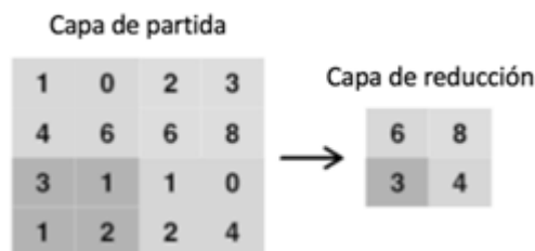
Fig. 3. Muestra el funcionamiento de la capa de reducción ( Pooling ).
