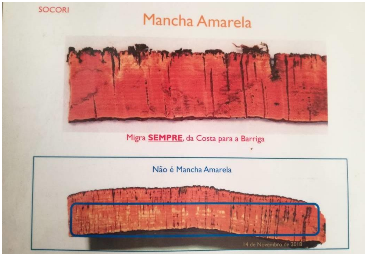
Figura A11- Ilustração de Defeitos: Mancha Amarela.
