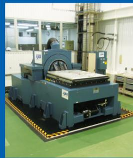
P14 小型振動試験設備
