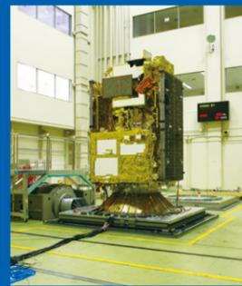
P13 大型振動試験設備
