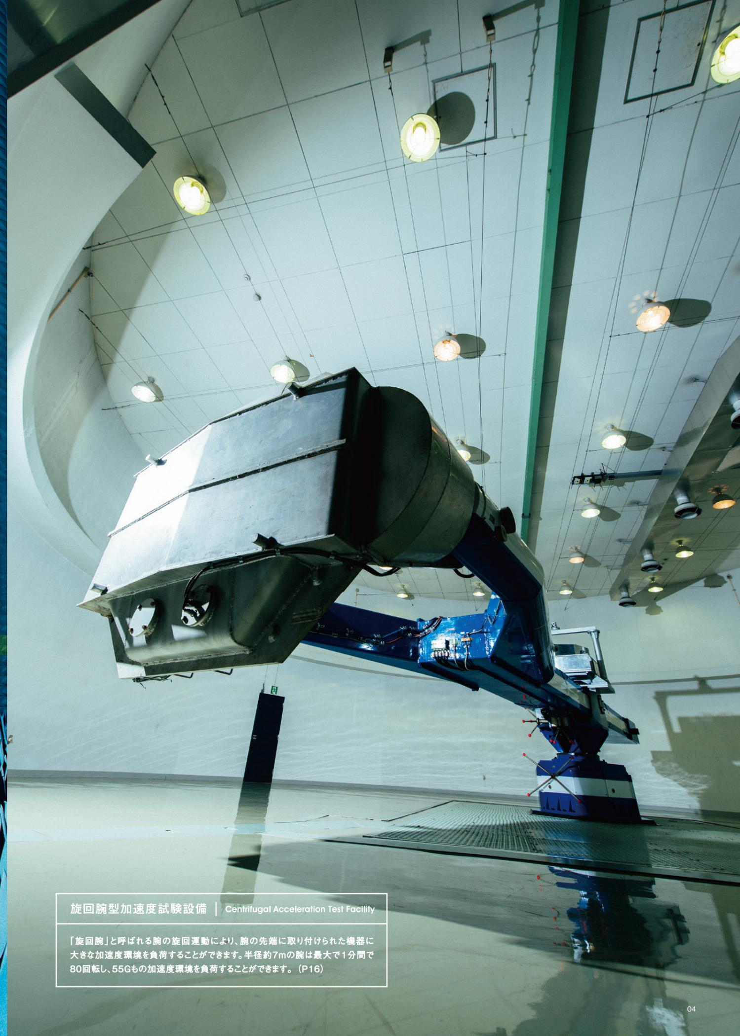
旋回腕型加速度試験設備 | Centrifugal Acceleration Test Facility
