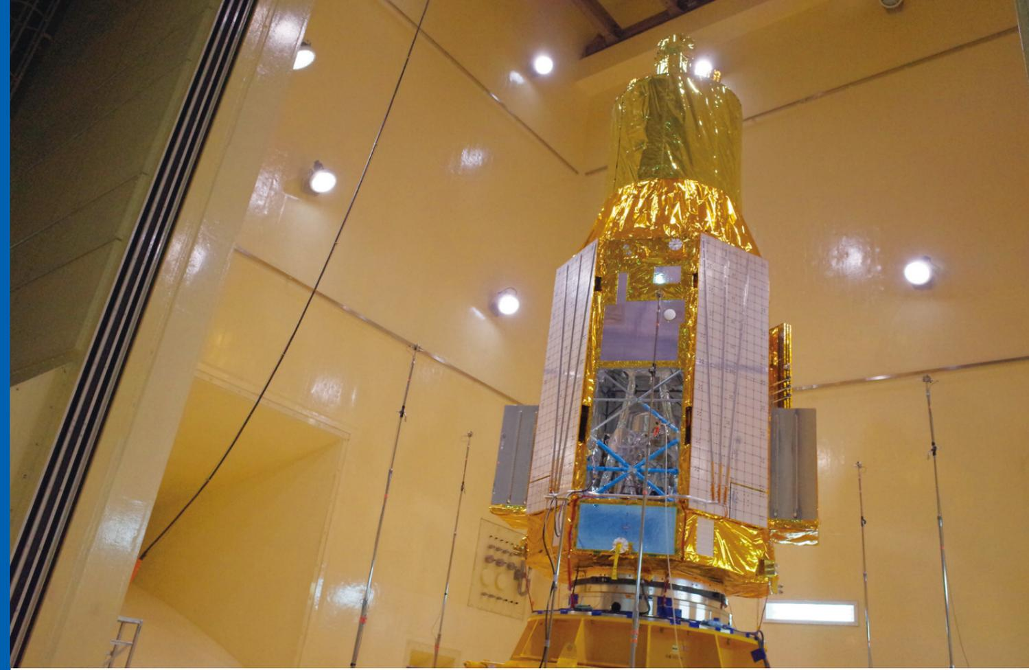
1600m³ 音響試験設備
