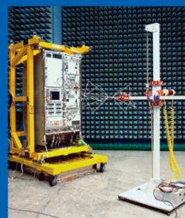
P21 電磁適合特性試験設備
