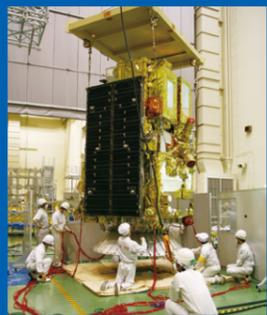
P15 大型分離衝撃試験設備
