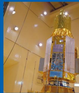
P12 1600m³ 音響試験設備
