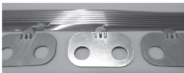
写真5 バスバーとFPCのハンダ接続
