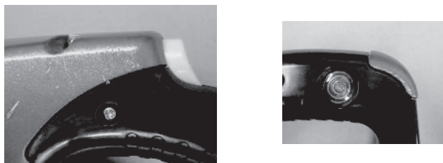
写真3 エッジ部への金属部の露出 (図5の○部の詳細)
