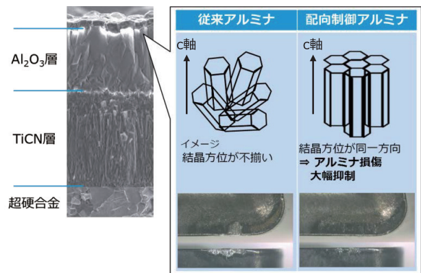
図8 アルミナ層の結晶配向性比較
