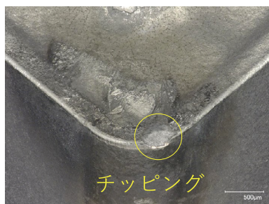
写真1 高能率加工における工具刃先の損傷例
