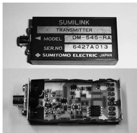
写真4 FDDI用光データリンク外観(上)と受信部構造(下) GaAs-FETによる受信フロントエンド部(+12V)、ゲイン不足のためブートストラップ回路でPD容量キャンセルし、受信帯域確保SOP-ICは当社初の光通信用カスタムIC(-5V動作)
