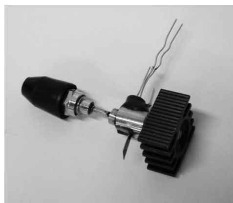
写真1 Hi-OVISに使用されたTOSA LED光源に、スタブファイバ、モニタPD、ヒートシンクが付いている。
