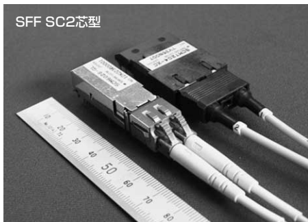
写真8 SFFとSC2芯型光データリンク SC2芯型光データリンクの幅が1インチであるのに対し、SFFトランシーバの幅は0.55インチと約半分のサイズになる。
