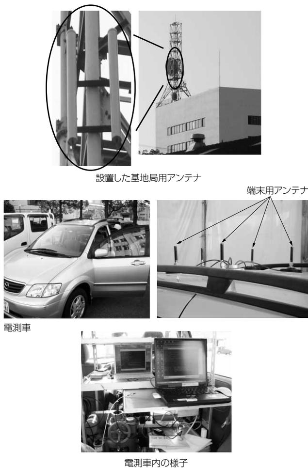
写真1 電測車と端末用アンテナおよび電測車内の様子
