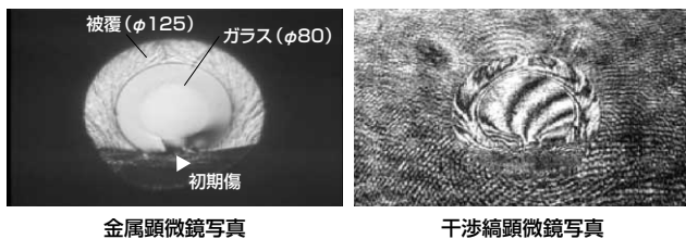
図7 被覆付きファイバのカット端面
