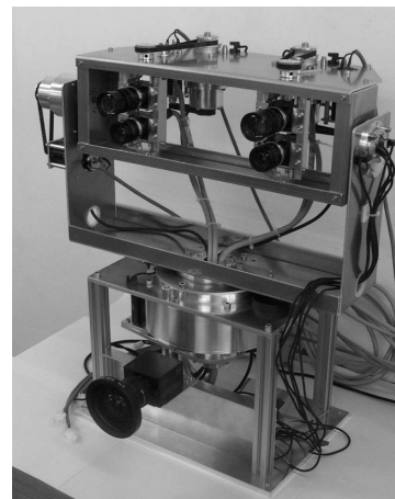
写真1 監視用両眼視覚センサー試作機
