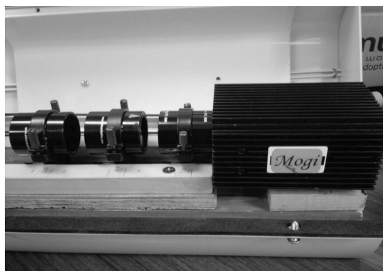
右端が赤外InGaAsセンサ 写真2 試作センサの光学系
