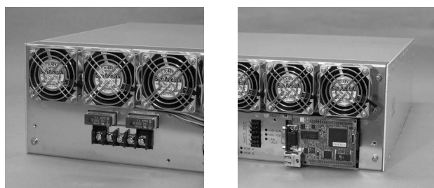
写真2 電源とSNMP基板配置写真 (左：従来品、右：SNMP基板)
