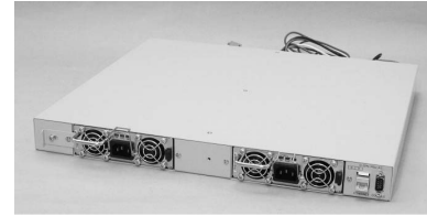
写真5 AC電源ユニット外観写真
