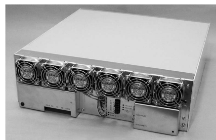
写真3 ファンユニット配置写真
