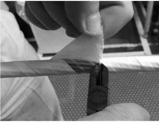
写真1 押さえ巻き除去作業
