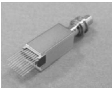
写真2 25G用小型光送信モジュール外形
