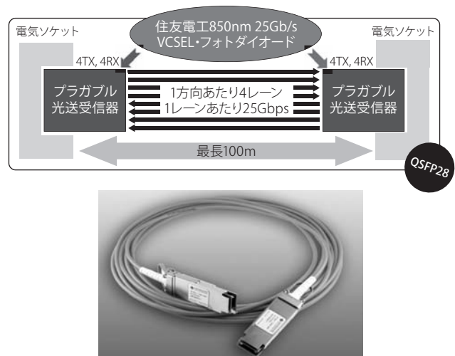
図9 EDRケーブルのブロック図（上）、インフィニバンドAOC（下）
