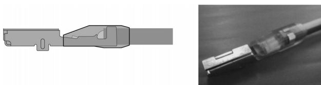
図15 アルミ電線圧着部のモールド構造
