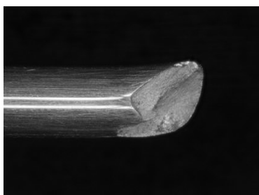
写真1 アルミ素線の断線
