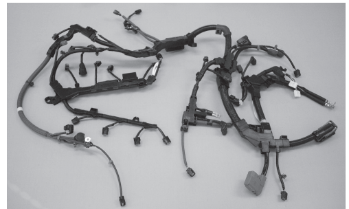
写真4 高強度アルミ電線を使用したエンジンワイヤーハーネス
