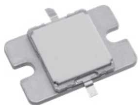
写真1 GaNHEMT EGN21C210I2Dの外観 (サイズ12.9mm×21.0mm)
