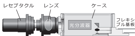
図3 4ch集積受信デバイスの構成模式図
