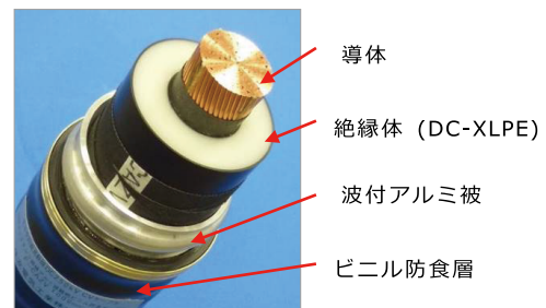
写真3 新北本ケーブル構造
