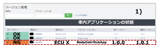
図9 システムはECU Xに搭載されているアプリケーションBodyCtrlSubAppのバージョンが最新バージョンでないこと検知する（図中破線部）。管理者は当該箇所をクリックして詳細を表示する。
