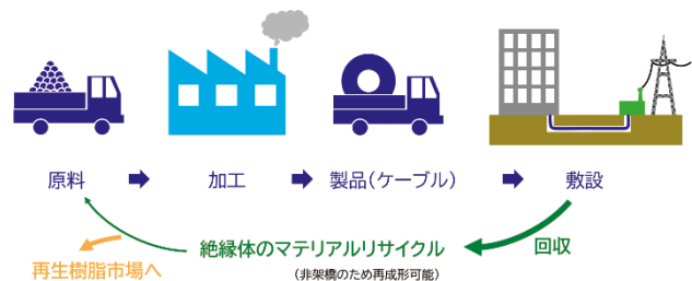
図1 非架橋絶縁電力ケーブルの流れ
