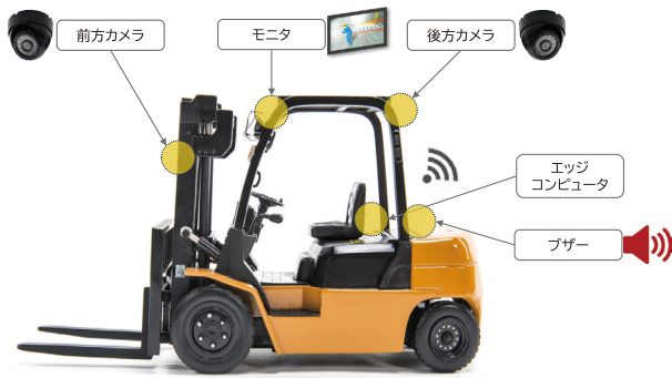
図1 フォークリフトシステム構成
