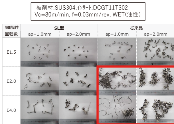
図4 振動切削時の切りくず分断性
