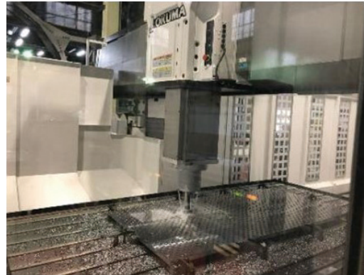
写真4 最新の門型マシニングセンタでの切削加工
