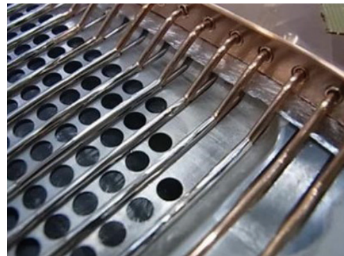
写真9 複数箇所同時の気密真空ロー付け事例
