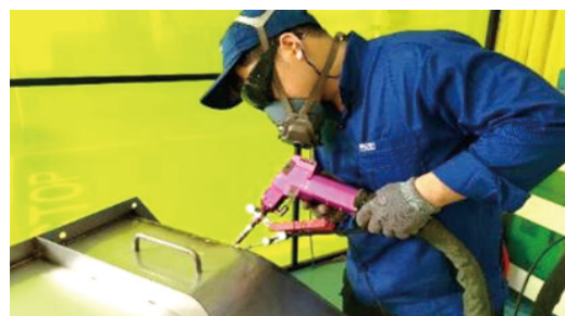
写真2 ファイバーレーザー溶接の活用
