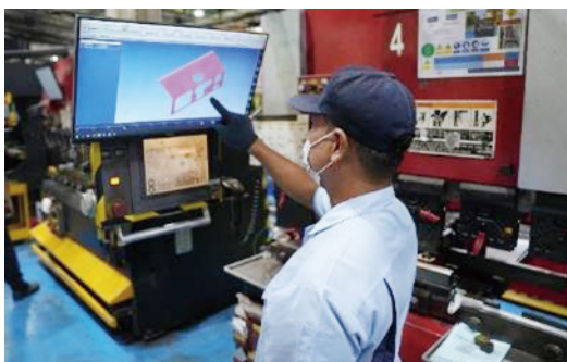
写真1 ディスプレイからの製作図面の呼び出し
