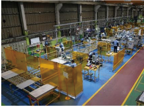
写真5 一貫のコンベア溶接ライン
