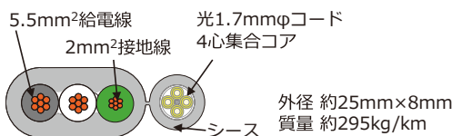
図2 今回開発の平形給電部光部セパレート構造複合ケーブル
