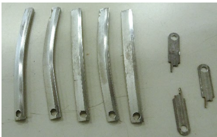
破壊したクリップ、鋼線刃の変形状況
