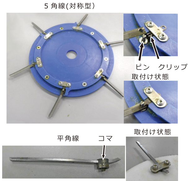
写真1 異形線を用いた刈刃
