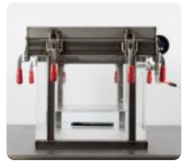
為了測試 IPX7/8 的防浸水保護，Apple 將 iPhone 浸入加壓容器中，以模擬在水下受到的壓力。
