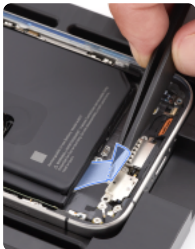
iPhone 電池使用先進的黏合劑固定，可在朝特定方向拉時鬆開，以便更換電池。
