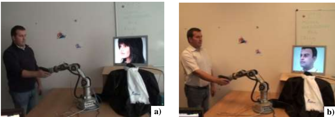
Figure 99 Montage expérimental pour la poignée de main entre l'humain et le robot (Pour améliorer le côté esthétique de cette expérience on a mis une image de l'être humain dans l'écran équipé d'un manteau et d'une écharpe).
