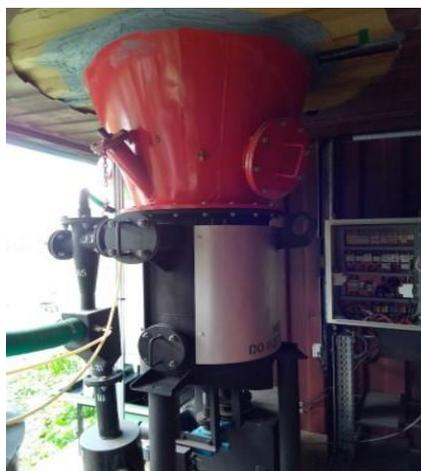
Figure 79: Gazéifieur à courant descendant de 11 kW
