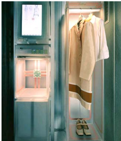
Abbildung 2: Ankleidekabine im Prada Epicenter Store in New York: Funketiketten in den Kleidern ermöglichen das Abspielen von passenden Videos mit Kombinationsvorschlägen (Bildquelle: www.ideo.com )
